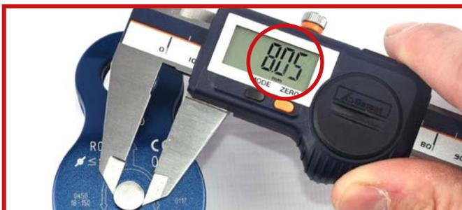
La tête du rivet présente un diamètre **inférieur à 8,7 mm** : cessez immédiatement d'utiliser la poulie et renvoyez-la à EDELRID pour la faire remplacer gratuitement.
