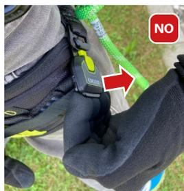
Wird die Schnalle nur am SlideBlock-Rahmen aufgekantet, wird die Klemmung des Bandes nicht aufgehoben und es kann kein Band aus der Schnalle gezogen werden.
