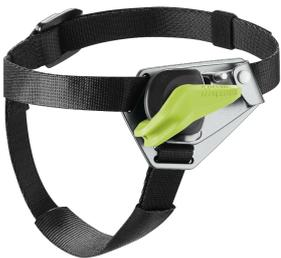
Ausgeklügelte Fußsteigklemme, die ein effizientes und ermüdungsarmes Aufsteigen am Seil ermöglicht. Eine vorinstallierte aber abnehmbare Seilsicherung verhindert unbeabsichtigtes Aushängen. Die Verriegelung des FOOT CRUISERS ist einfach zu bedienen – selbst mit den Füßen. Die Steigschleufe ist mit einem Abriebschutz versehen. Der FOOT CRUISER ist jeweils in einer Version für den rechten und den linken Fuß verfügbar.
