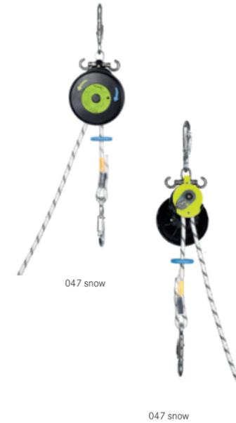
Das Safe Descent ist ein innovatives Abseil- und Rettungsgerät mit Hubfunktion, ideal für den Dauereinsatz in Adventure Parks und Trainings Centern. Die patentierte Rücklaufsperre in Kombination mit dem Handrad ermöglicht die Rettung verunfallter Personen. Die Hubfunktion erlaubt die Entlastung der Sicherungskette bzw. Kraftübertragung auf den Safe Descent für das anschließende sichere Ablassen.
